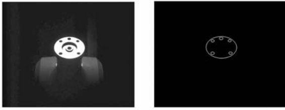
(a) 法兰盘图像 (b) 椭圆轮廓 (a) Flange image (b) Ellipse contour of flange
